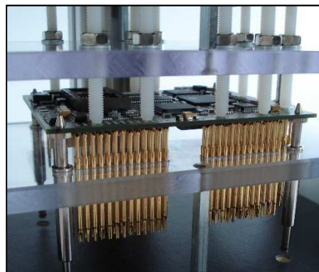
Der Prüfling wird von den Niederhaltstiften nach unten gegen die Federkontaktstifte gedrückt
