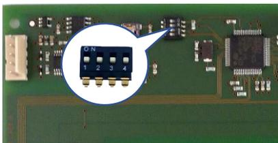
Schalter 1 ist für die Controllerprogrammierung reserviert und muss immer auf OFF stehen. Schalter 2 steuert die Polung der Messkarte. Die Standardeinstellung ist ON (AC17=Plus, AC19=Minus). Die Stellung OFF verpolt die Messeingänge (AC17= Minus, AC19=Plus), was der Abwärtskompatibilität von älteren ADX1 Karten dient. Hinweis: Geänderte Schalterstellungen werden erst nach einem PowerUp übernommen.
