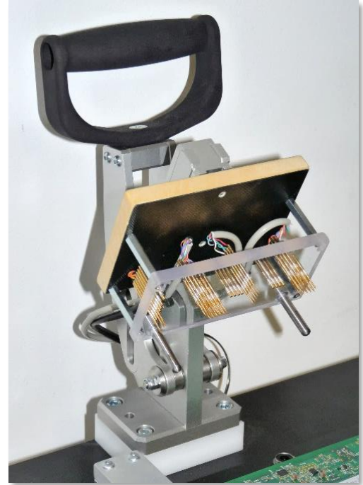
Anwendungsbeispiel: Kontaktierung von Testpunkten von oben
