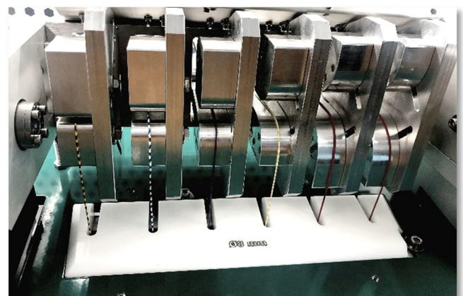
Schwenkbügel mit unterschiedlichen Biegesegmenten
